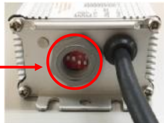
ネジを緩めることで調整用のディップスイッチが出現します
